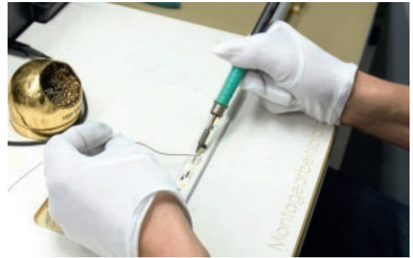
Bild 15. Manueller Lötprozess von LED-Leuchtbändern
